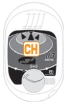
Il secondo localizzatore deve ora essere impostato su Trasmissione. Dopo la commutazione del localizzatore d3 nella modalità Ricezione, è possibile udire il segnale dell'apparecchio trasmittente, sul display viene visualizzata la distanza tra i due dispositivi e le tre frecce indicano la direzione da seguire. La spia di controllo è impostata sulla modalità di ricezione.
