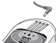
Il localizzatore d3 è provvisto di un collegamento per auricolari utile per la ricerca da parte di più soccorritori.
